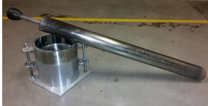
Figura 13. Molde cilíndrico y martillo metálico de Próctor modificado
