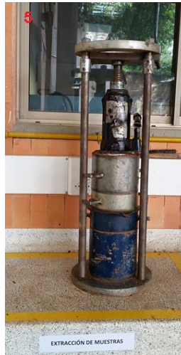
Figura 20. Desplazamiento de suelo hacia el collar de extensión del Próctor para facilitar remoción del material
