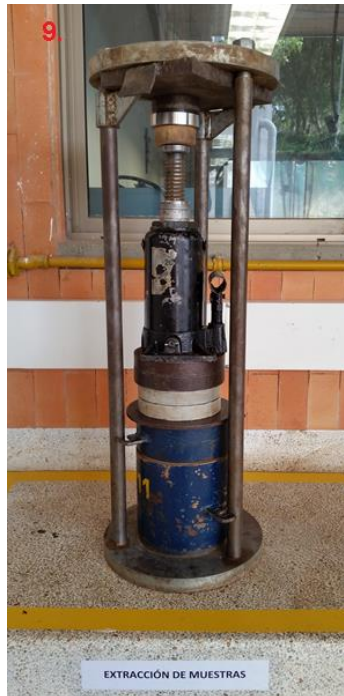
Figura 23. Desplazamiento del espécimen del tubo tomamuestras
