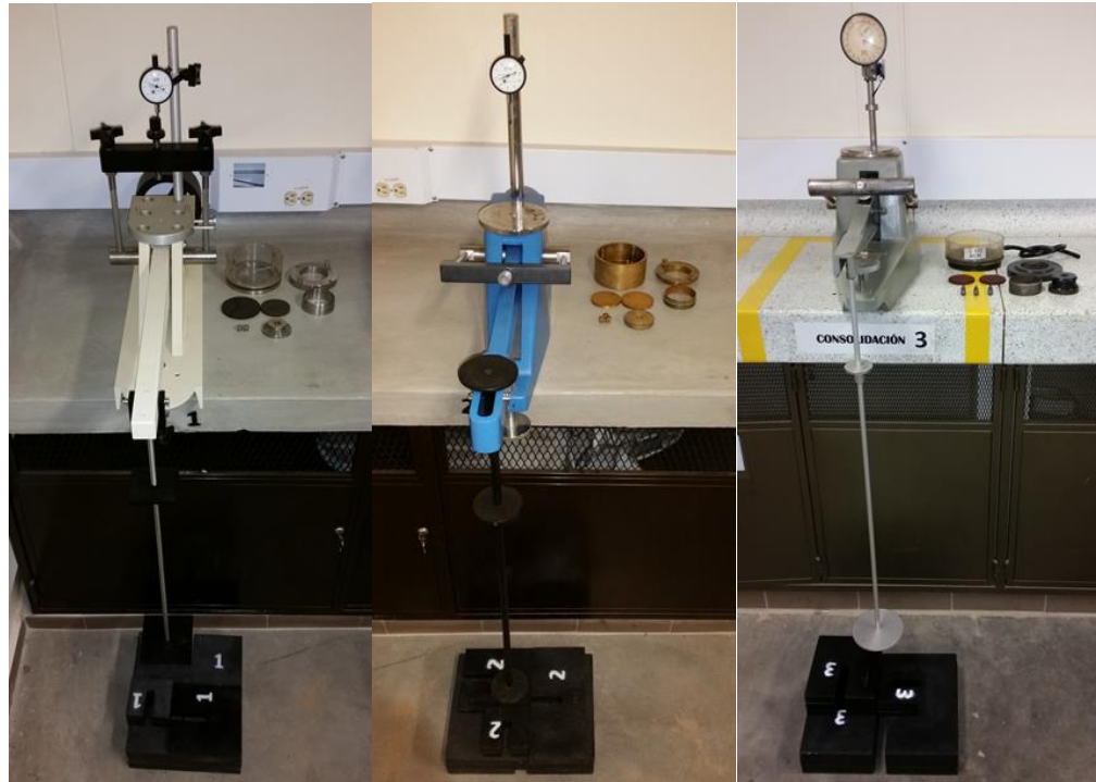
Figura 28. Consolidómetros del laboratorio de suelos con sus respectivos dispositivos de carga
