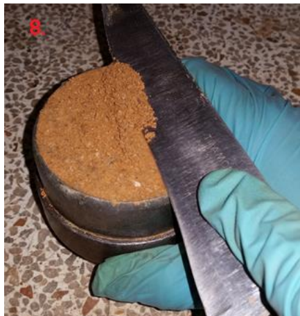
Figura 22. Forma en que debe enrasarse el espécimen antes de ser extraído del tubo tomamuestras
