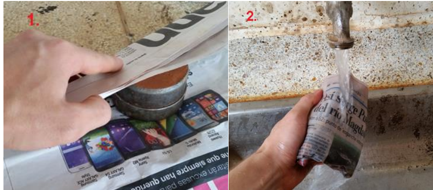
Figura 26. Ejemplo de método inadecuado para la incubación de especímenes
