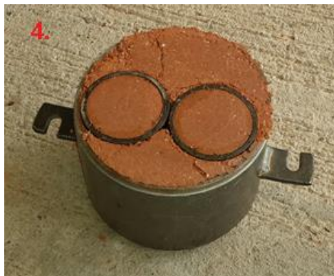
Figura 19. Tubos tomamuestras recién hincados en el cilindro de Próctor modificado
