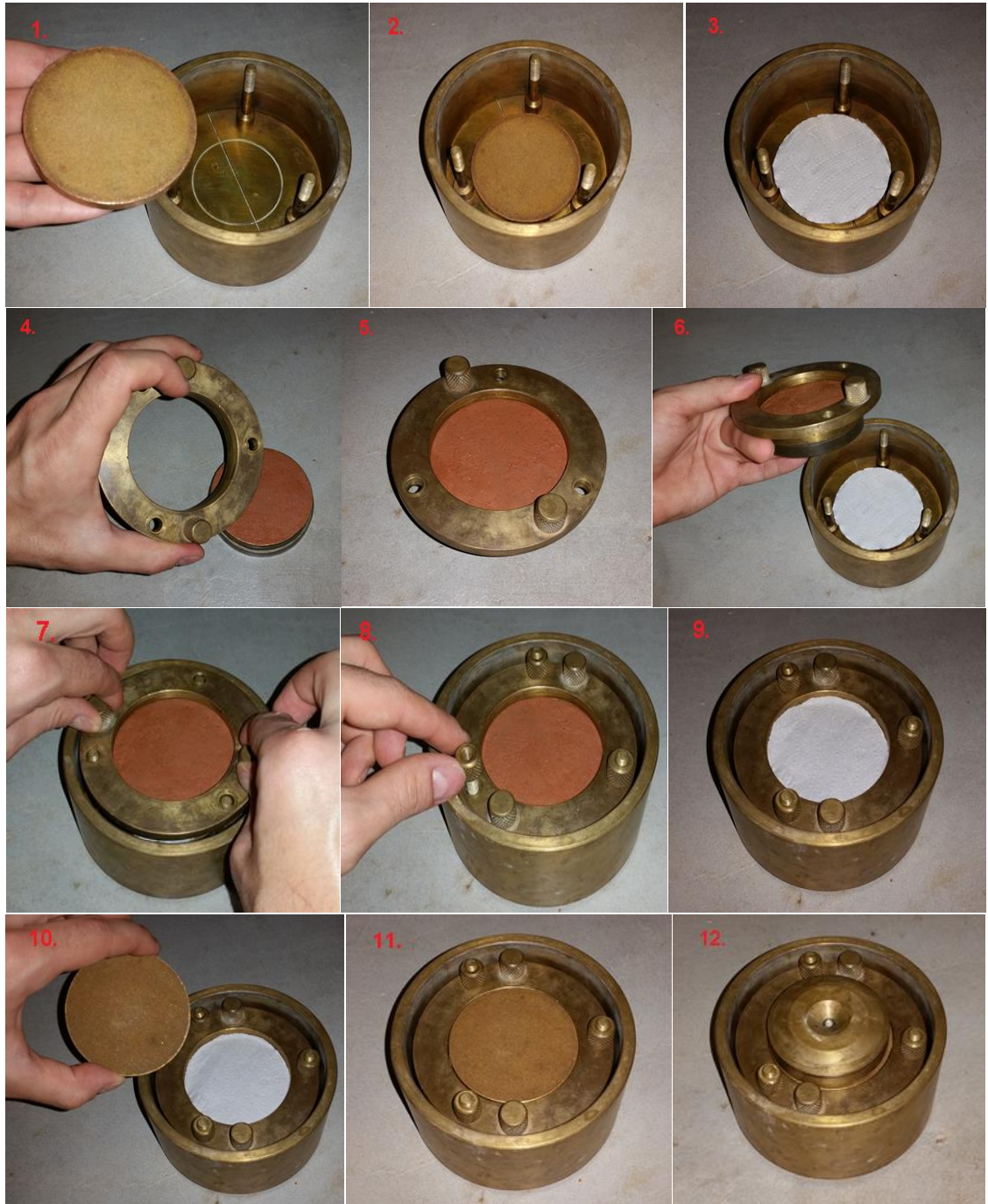
Figura 29. Infograma correspondiente al procedimiento del ensamble del conjunto del consolidometro
