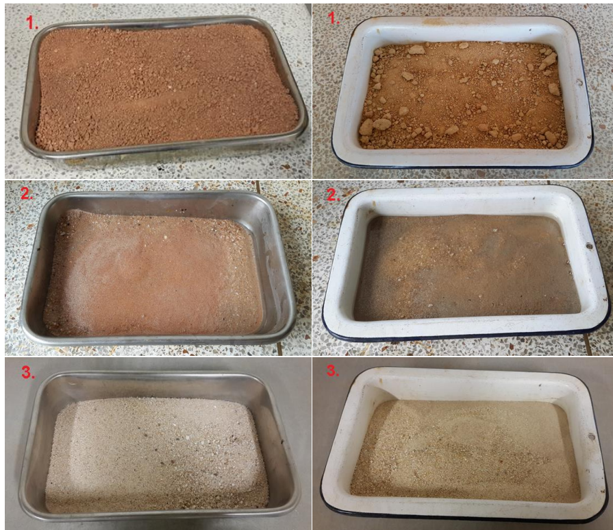
Figura 12. Infograma correspondiente al procedimiento del ensayo de granulometría para suelos areno arcillosos (izquierda) y areno limosos (derecha)
