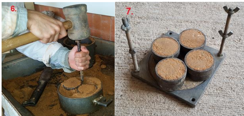
Figura 21. Extracción de los tubos tomamuestras del cilindro de Próctor mediante cincel y martillo
