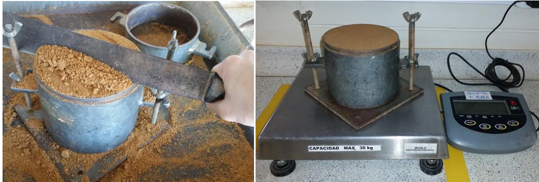
Figura 15. Enrasado y pesado del cilindro de Próctor modificado
