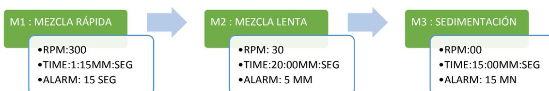
**Figura 8. Esquema con las condiciones de mezcla del equipo de jarras**
