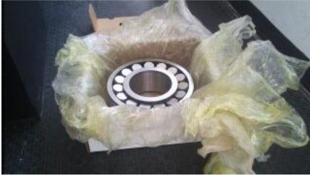
Figura 33 Rodamiento 22322 EK recuperado para ser enviado a la mina San Jorge. Fuente: Autor
