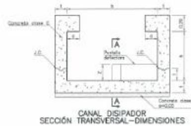
Figura 6 Sección transversal canal disipador
