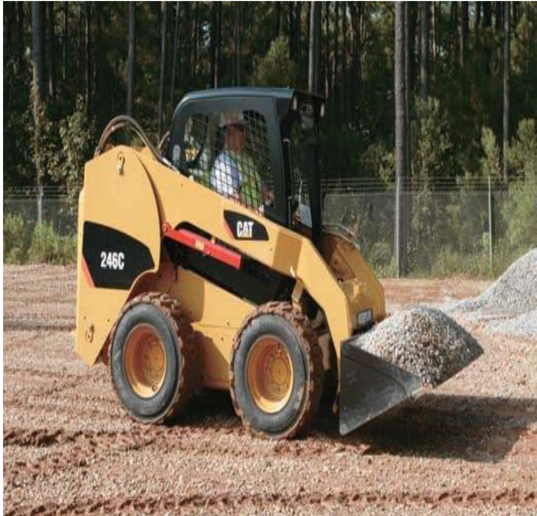
Imagen 10. Ejemplo del equipo Minicargadores.
