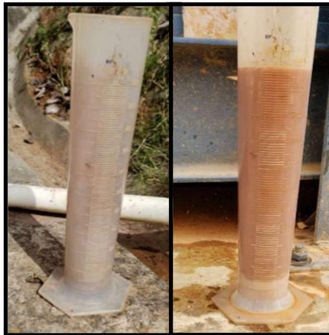
Tras dejar en reposo el recipiente, presentado en la figura 33, se procedió a calcular las alturas de las distintas capas con el fin de obtener el porcentaje de arena, limo y arcilla.
