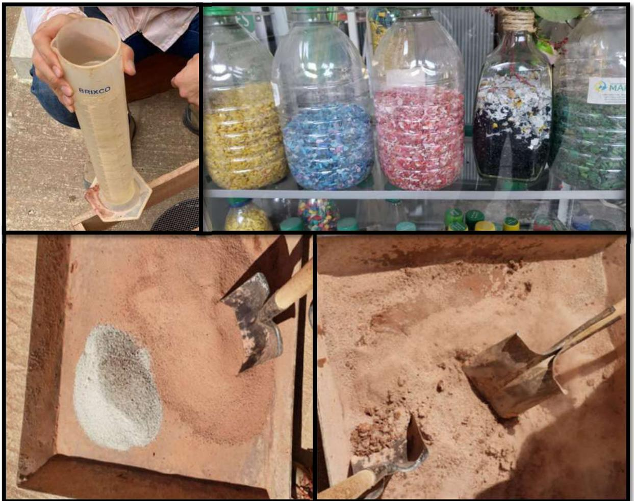
La mezcla se humedece con agua hasta alcanzar la humedad óptima y se coloca en un molde para darle forma al bloque, dicha humedad óptima se obtuvo de un 10% como se nos indicó en la figura 26 la curva de compactación.
