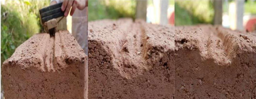
Figura 43 - Ensayo de Abrasión en BTCE RDC 30%, 15 Pasadas
