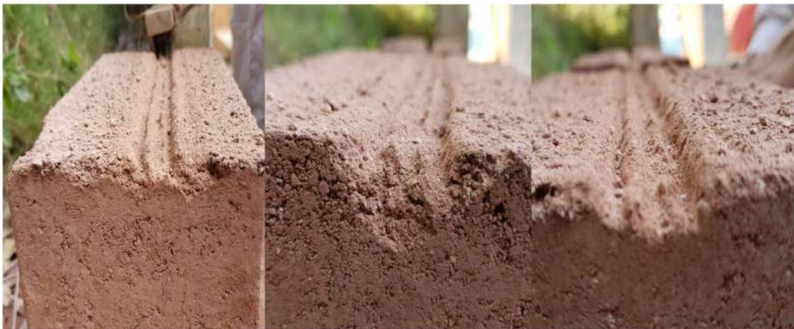
Figura 42 -Ensayo de Abrasión en BTCE RDC 30%, 10 Pasadas
