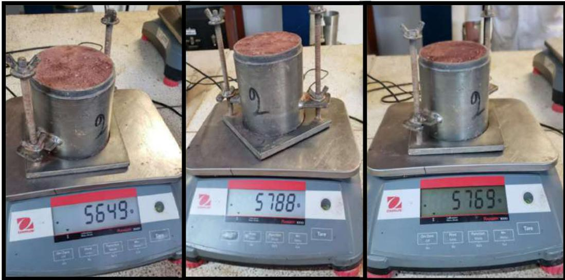
Se grafican los resultados obtenidos en una curva de compactación, que muestra la relación entre la densidad seca y el contenido de humedad del suelo compactado, la curva se presenta en la figura 26 a partir de los datos recolectados en la tabla 9
