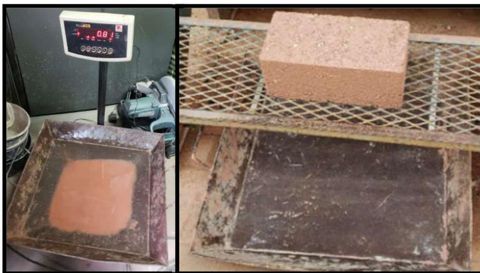
Recolectando los datos del peso seco, saturado, el tiempo de absorción, la cantidad de agua absorbida, expulsada y las pérdidas de agua permiten obtener la velocidad de trasmisión de agua con la siguiente ecuación 5.
