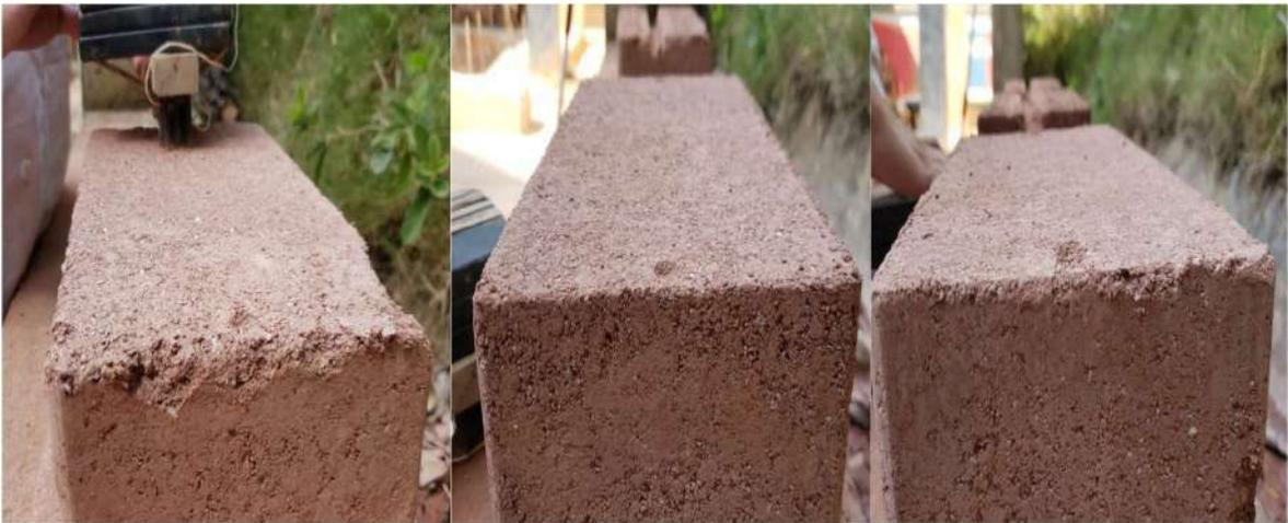
Figura 41 -Ensayo de Abrasión en BTCE RDC 30%, 5 Pasadas
