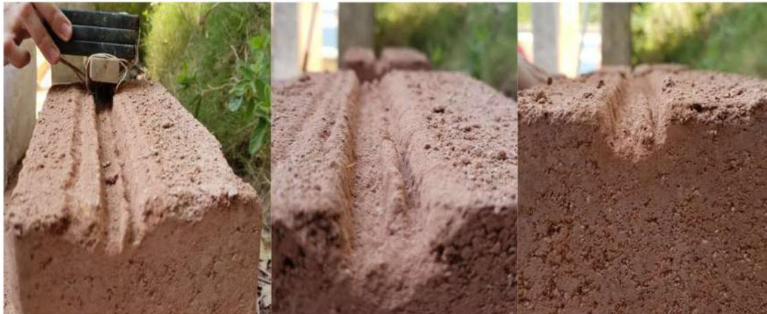
Figura 44 - Ensayo de Abrasión en BTCE RDC 30%, 20 Pasadas
