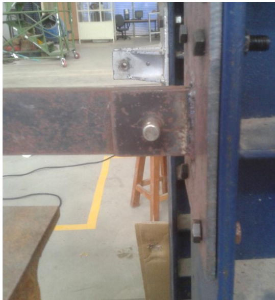
Figura 33. Platina inferior conecta a barra rígida de acero
