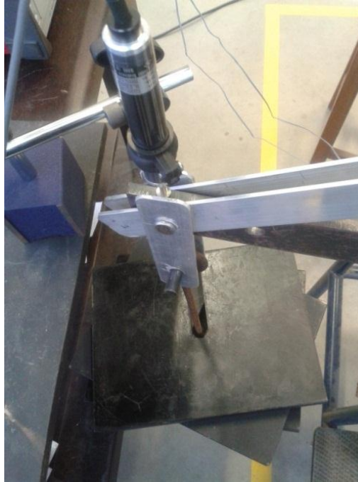
Figura 37. Ubicación del Transductor de Desplazamiento
