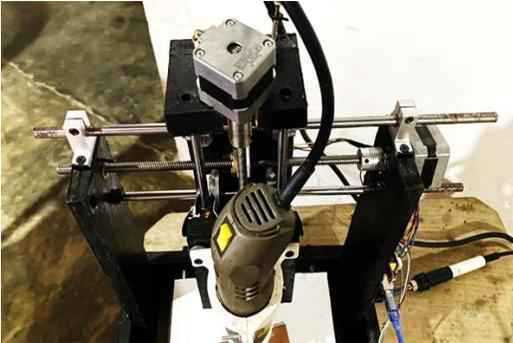
Nota: se observa desde vista frontal superior la instalación del soporte para el dispositivo de fresado tomado de (autor).
