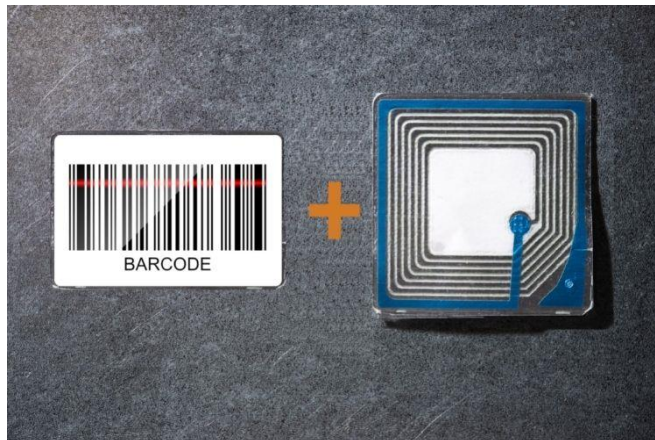
Figura 3. Código de barras y etiqueta RFID. (Tecnipensa, 2022)
