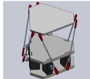
Figura 1.17. Robot paralelo espacial - Plataforma Stewart (Crawford, 2020).
