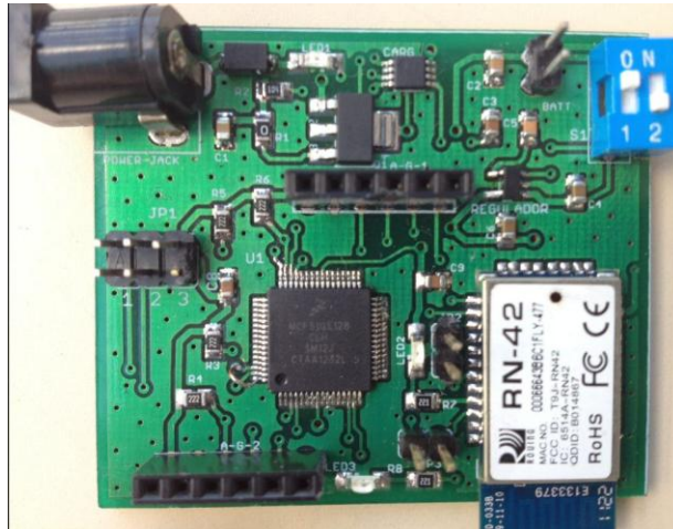
Figura 25: Tarjeta con todos los dispositivos ensamblados.
