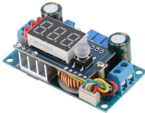
**Figura 7. Sensor regulador de carga (Mppt 5A) Fuente;**
