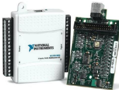
**Figura 4. NI-DAQ 6008 Controlador ni-usb-6008 DAQ (Halvorsen, 2017) Fuente:**
