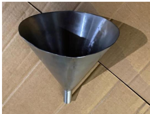
Figura 16. Embudo para envasar el producto final. Fuente: Fotografía tomada en la empresa ACLYC S.A.S.
