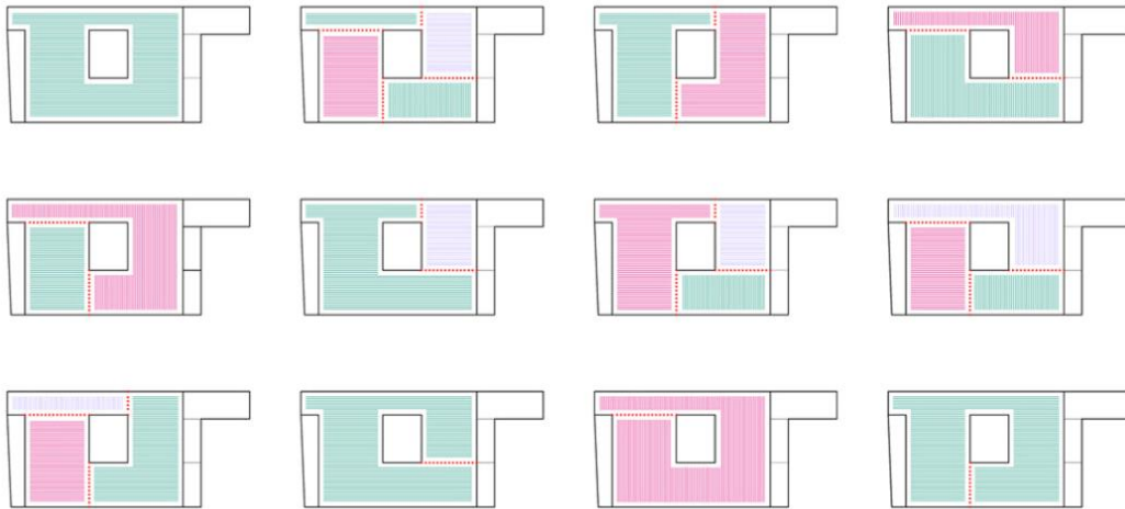
Imagen 34. Secuencia de imágenes del arquitecto de los movimientos posibles de los paneles móviles.
