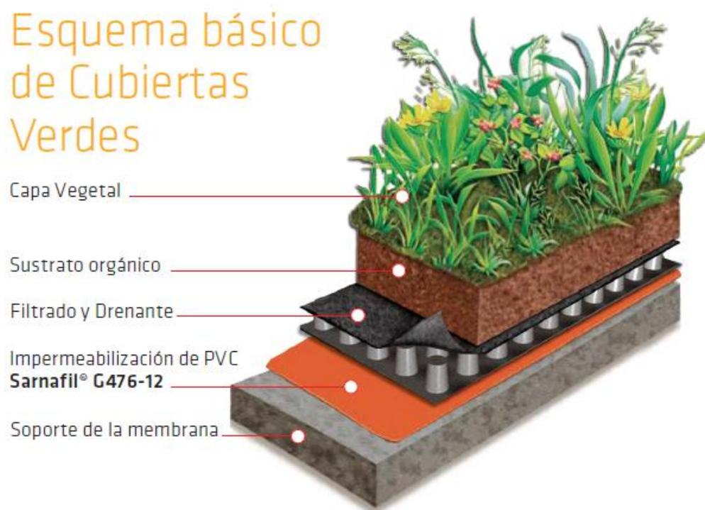
*Nota.* En la figura se ilustra mediante esquema, los componentes básicos de instalación de una Cubierta Verde, que, como alternativa de las cubiertas tradicionales, significa un avance valioso en el diseño de edificios sostenibles, así mismo la adición de un techo verde a un área árida de un edificio ofrece ventajas y beneficios sociales, ambientales y económicos. Adaptado de *CUBIERTAS VERDES VENTAJAS Y BENEFICIOS SOCIALES, AMBIENTALES Y ECONÓMICOS* (SIKA, 2021).
