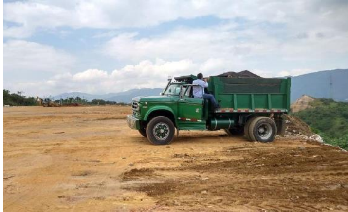
Figura 9 Vehículo carpado hasta la zona de descarga
