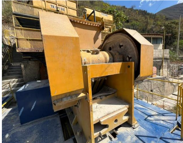
Figura 19 Trituradora de cono de trituración secundaria de 3 pies 100 Tn/h Mandíbula primaria de 12" *24"
