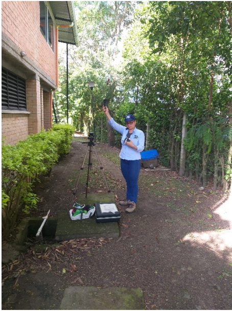
Foto 9. Equipo sonómetro instalado en módulo 2 y medición de la velocidad del viento. Fuente: propia.
