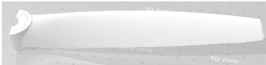
Figura 13. Modelo 3D de una pala de la hélice 9X4
