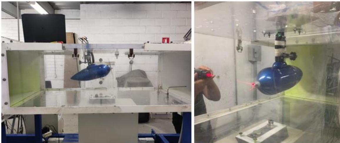
Figura 33. Banco de pruebas montado en el túnel de viento subsónico de la UPB.
