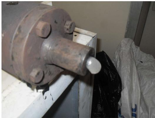
**Figura 65. Fin del proceso de extrusión durante las pruebas. Imagen tomada por Diego Galvis y Jorge Rubio.**
