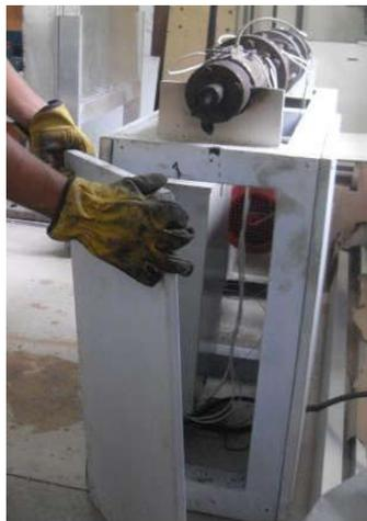
**Figura 76. Retiro de Tapa Frontal de Máquina Extrusora. Imagen tomada por Diego Galvis y Jorge Rubio.**
