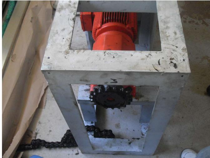
**Figura 18. Ubicación del motor en la estructura. Imagen tomada por Diego Galvis y Jorge Rubio**
