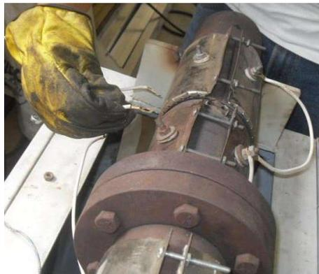
**Figura 82. Remoción de cable en resistencia. Imagen tomada por Diego Galvis y Jorge Rubio.**
