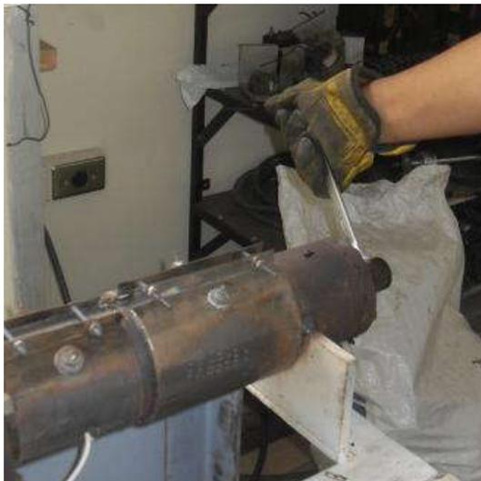
**Figura 84. Destorqueo de pernos de boquilla. Imagen tomada por Diego Galvis y Jorge Rubio.**
