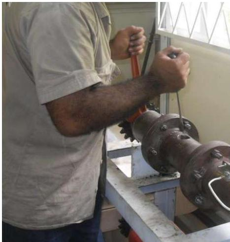
**Figura 86. Movimiento con palanca y llave para sacar sin fin. Imagen tomada por Diego Galvis y Jorge Rubio.**
