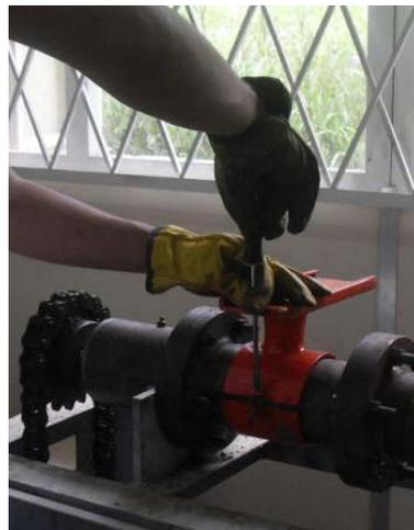
**Figura 72. Retiro de Tornillos de base de Tolva. Imagen tomada por Diego Galvis y Jorge Rubio.**
