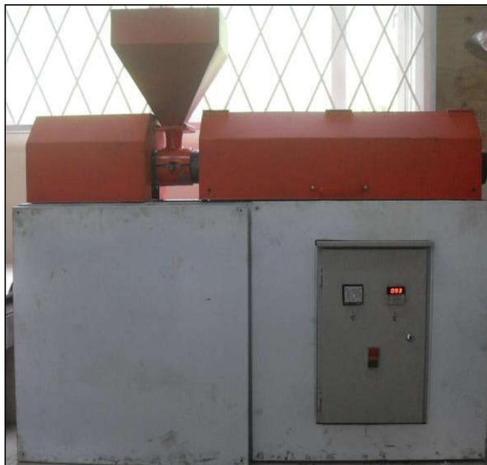
**Figura 66. Maquina Extrusora. Imagen tomada por Diego Galvis y Jorge Rubio.**
