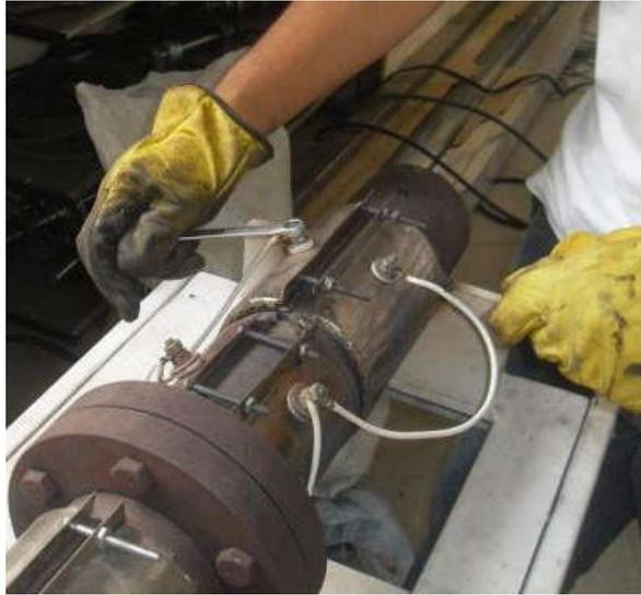
**Figura 81 Afloje de Tornillos de cable de resistencias. Imagen tomada por Diego Galvis y Jorge Rubio.**
