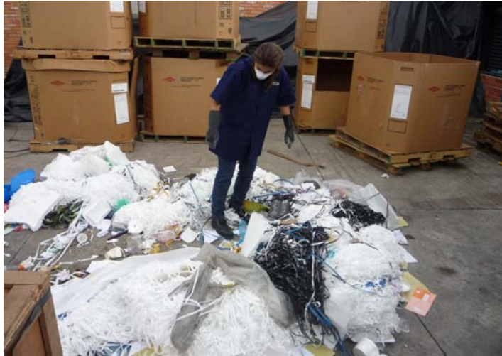
Figura 12. Proceso de cuarteo, homogenización de los residuos sólidos ordinarios.
