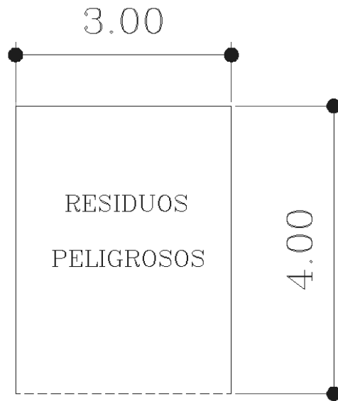
Figura 23. Diseño del cuarto de residuos peligrosos.
