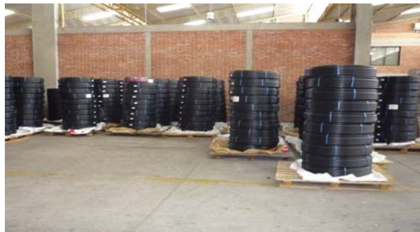
Figura 9. Tubería para protección de redes.
