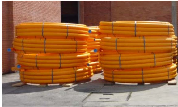
Figura 5. Tubería de gas polietileno.
