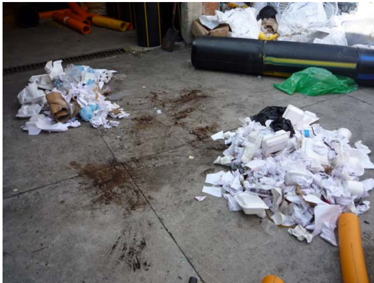
Figura 13. Separación en cuatro partes iguales de residuos sólidos ordinarios.
