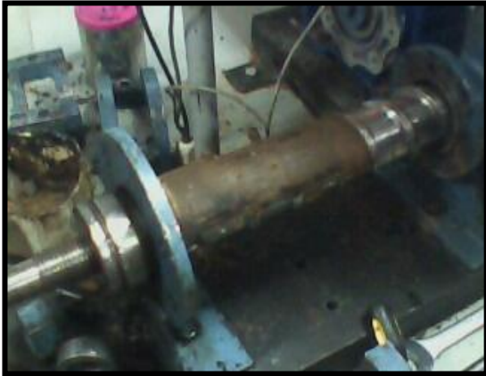
Figura 66. Residuos de torta en el tornillo
