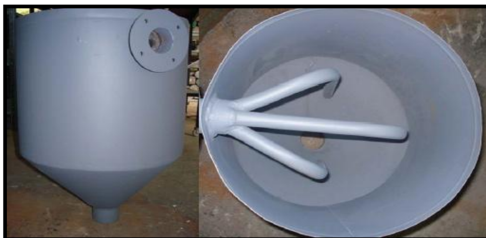
Figura 9: ductos de calentamiento y humidificación anterior [2]
