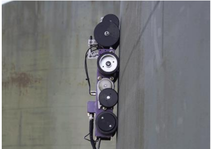
Figura 9. Crawler para inspección de espesores en tanques.
