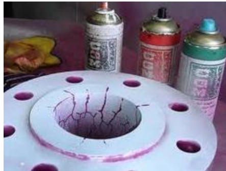
Figura 5. Método de líquidos penetrantes para inspección superficial.
