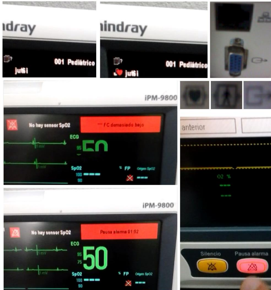
Figura 5. Pruebas en video - Verificación de sonidos, pausa de alarmas, iconografía de interfaz e iconografía externa.
