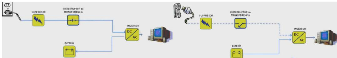
**Fig. 12 funcionamiento interno de UPS APC LINEA INTERACTIVA con y sin energía. Fuente:** <sup>28</sup>
