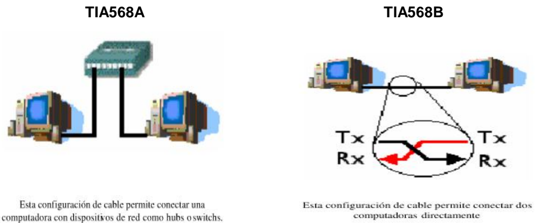
FIG. 10. TIPOS DE CONEXIÓN EN CADA UNA DE LAS CONFIGURACIONES DE LA NORMA TIA 568 A/B 10
