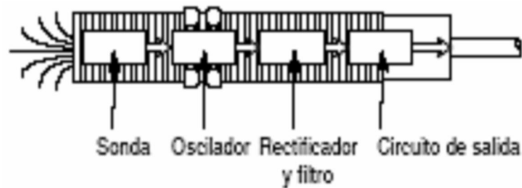
FIG. 4. ESTRUCTURA INTERNA DEL SENSOR CAPACITIVO 4
