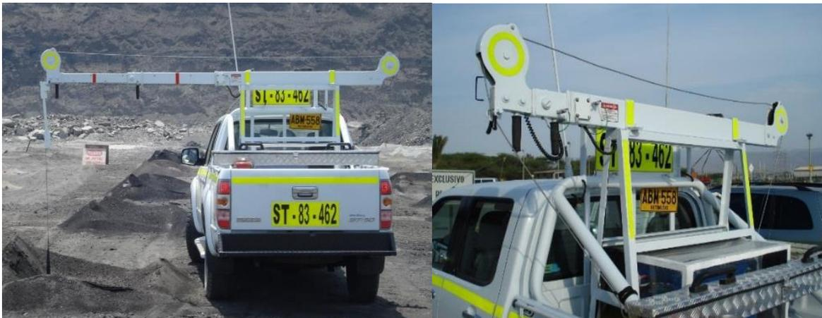
Figura 11. Estructura de la camioneta actual de registro. *Fuente: autor*
