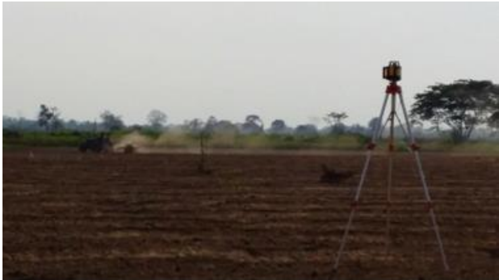
Imagen 1. Foto en lote del funcionamiento del laser Leica Rugby
