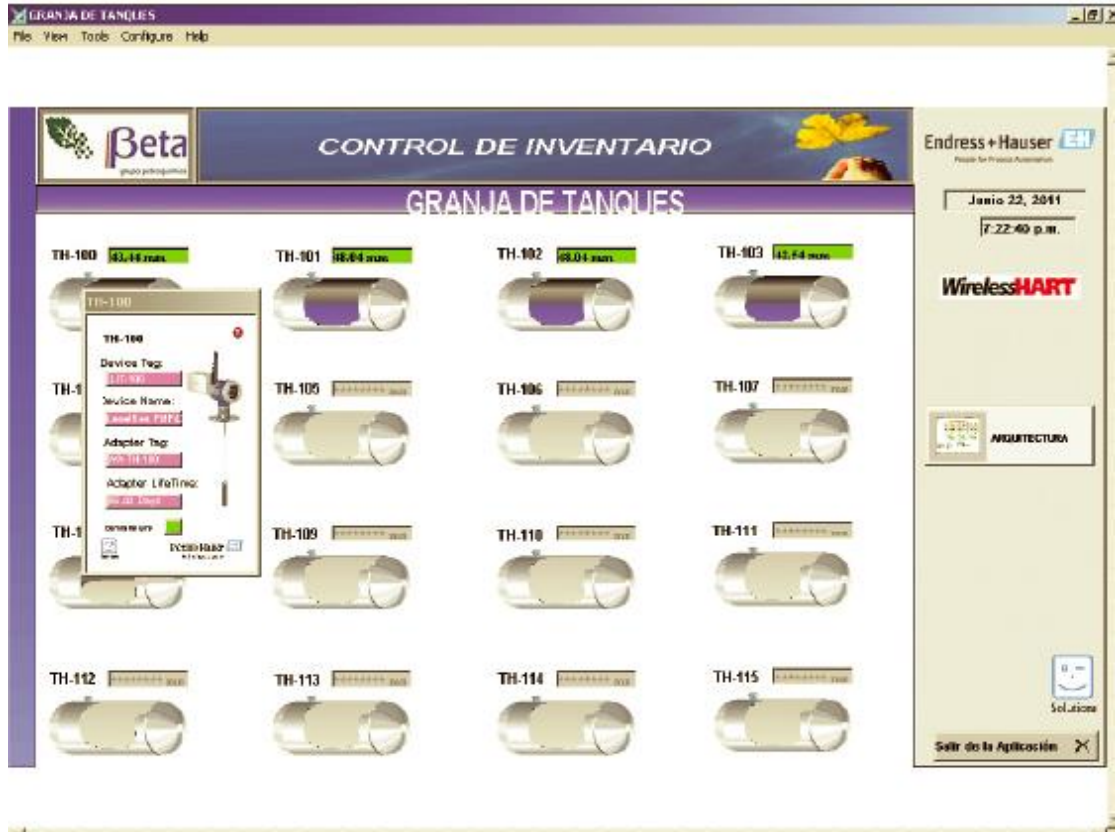
Figura 17. HMI control de inventarios tanques Beta
