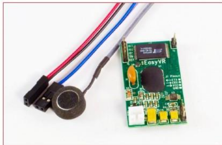
Figura 6. Módulo EasyVR, imagen tomada de: guía rápida del módulo de reconocimiento de voz y reproducción, EasyVR.
