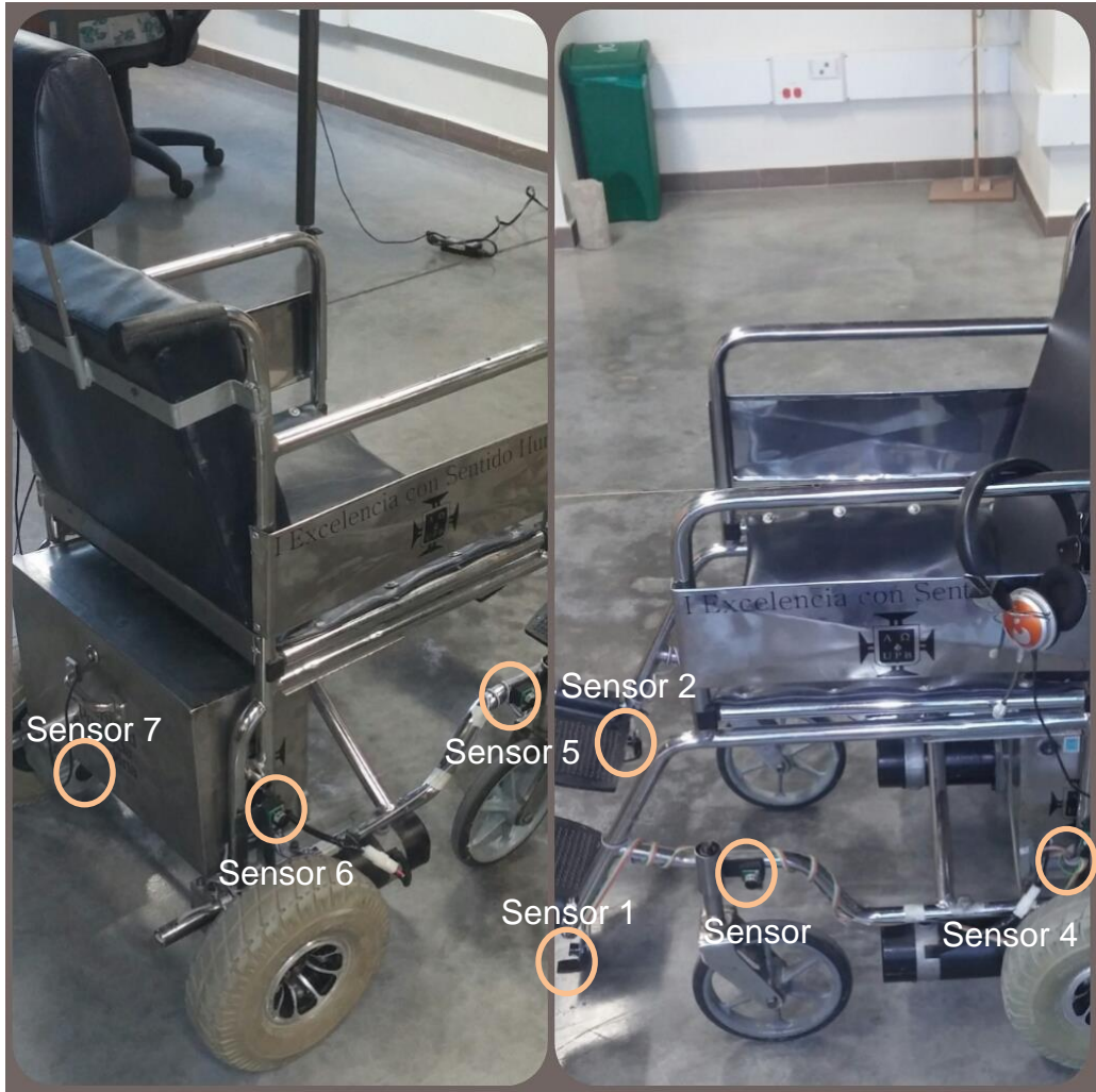
Figura 11. Ubicación de los sensores ultrasónicos SRF02
