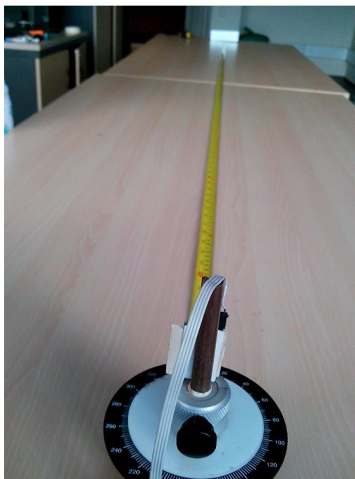
Figura 13. Procedimiento para la detección del ángulo máximo del sensor SRF02
