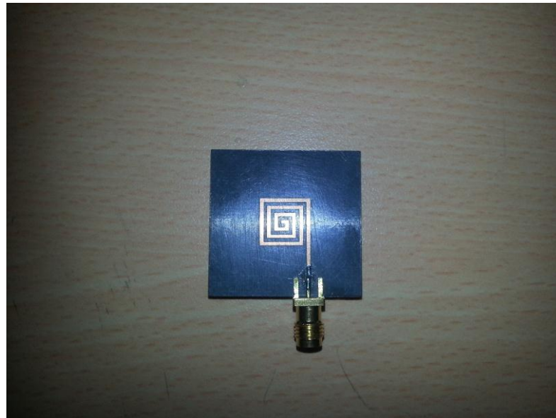
Figura 36. Construcción antena número 3.
