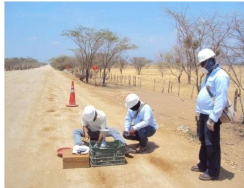
Imagen 6: Ensayo de densidad por método del cono de arena, para la capa de subbase
