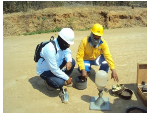
Imagen 3: Ensayo de densidad por método del cono de arena, para la corona de terraplén
