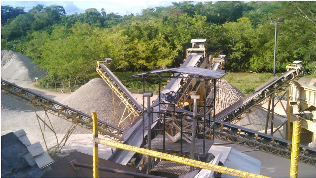
Imagen 9: Planta trituradora Puentes Sogamoso.
