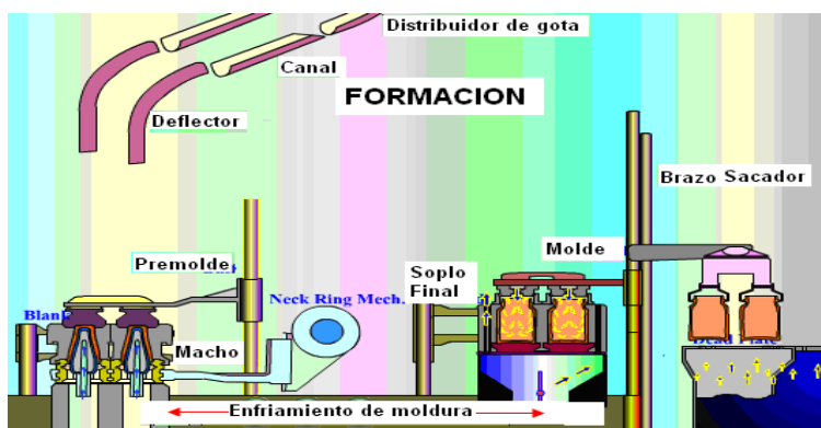
Fig. 6 Proceso de formación del envase
