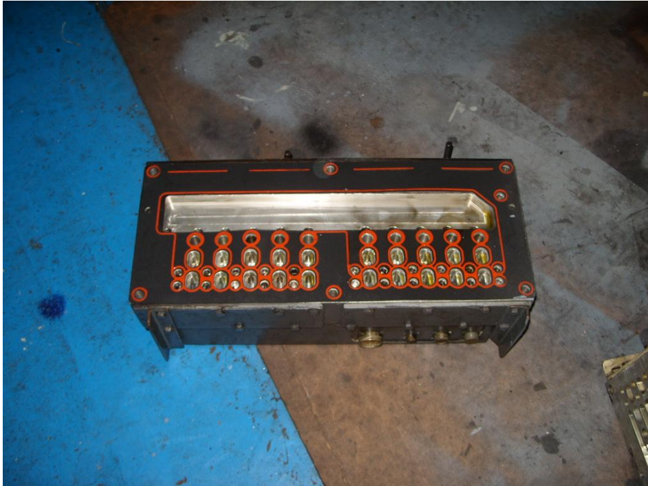
Fotografía. 22 Bloque de Válvulas
