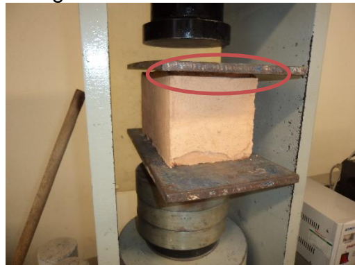
Figura 53. Error al fallar murete A 2
