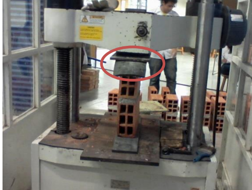
Figura 55. Ensayo de compresión de muretes H10
