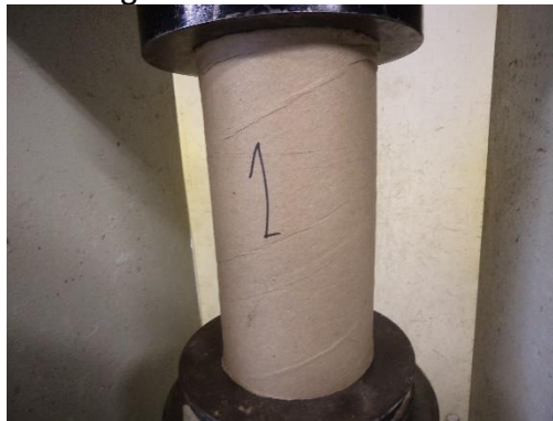
Figura 36. Falla del tubo.
