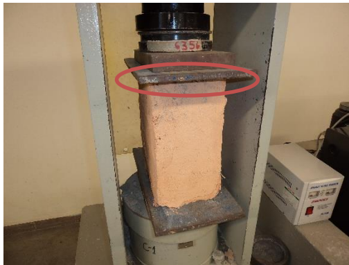
Figura 52. Error al fallar murete A 1
