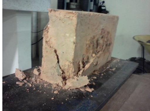
Figura 50 . Mampuesto arcilla-yeso 2-1. Figura 51. Mampuesto A-Y-Ps
