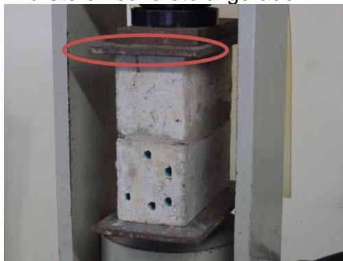
Figura 54. Error al fallar murete en concreto aligerado.
