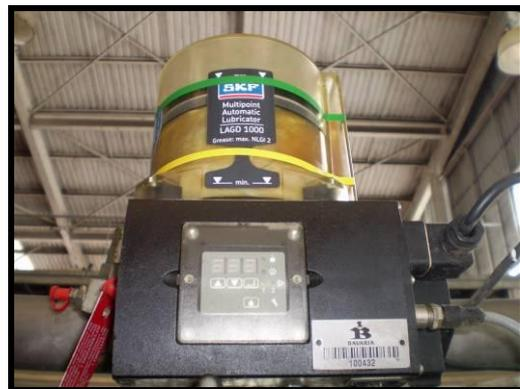
**Imagen 69 punto de lubricación Automatizado. Tomado de [Autor].**
