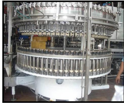
**Imagen 54. Tomado del [Autor] “Ensamble carrusel y nuevo rodamiento”**
