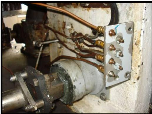
**Imagen 68 puntos de lubricación Tomado de [Autor].**
