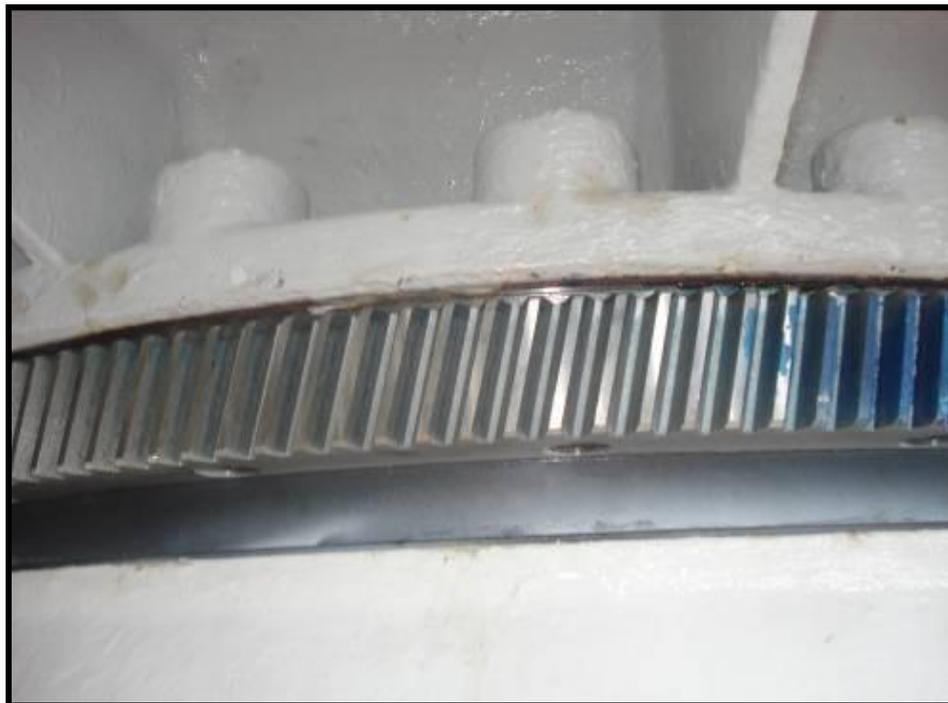
**Figura 55 Tomado de [Autor] “Nuevo rodamiento principal ya instalado”**
