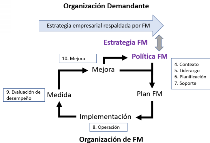
Figura 3.3. Ciclo de mejora continua por metodología del enfoque de procesos en el estándar ISO 41001. (Figura adaptada de UNE, 2018)
