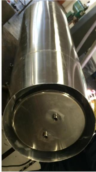
**Figura 18.** Tanque externo hecho en lámina de aluminio, fuente: autores del proyecto.
