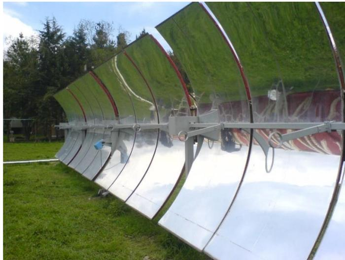
**Figura 9. Colector Concentrador Parabólico<sup>7</sup>.**
