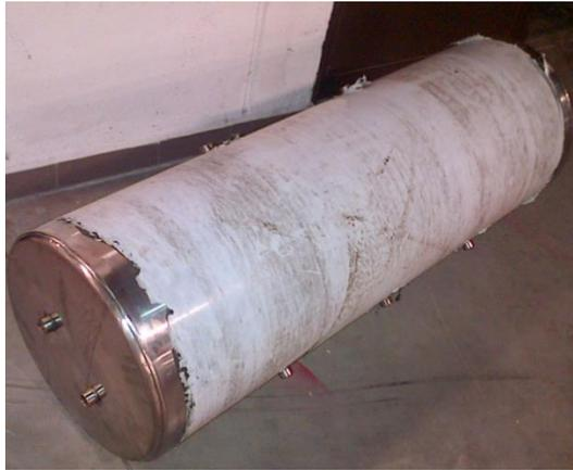
**Figura 17.** Tanque interno hecho en acero inoxidable, fuente: autores del proyecto.
