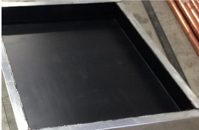
**Figura 20.** Placa absorbedora, fuente: autores del proyecto.
