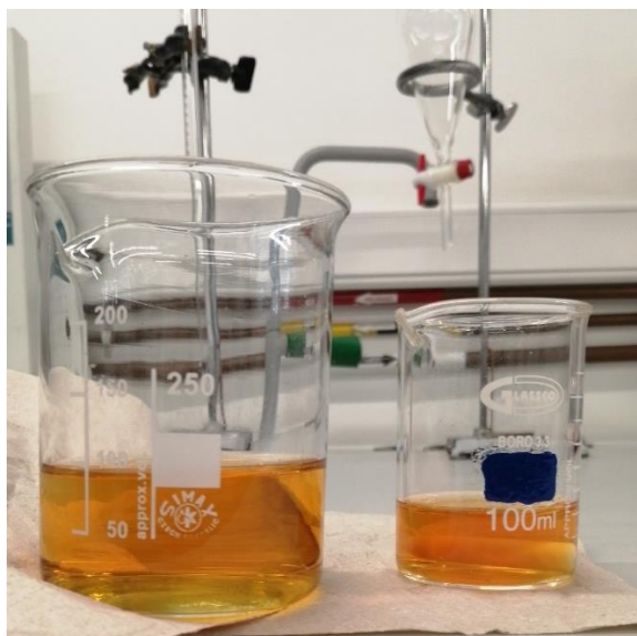
Figura 15. Soluciones de GQDs interrumpidas y siendo neutralizadas a pH 7 con NaOH.
