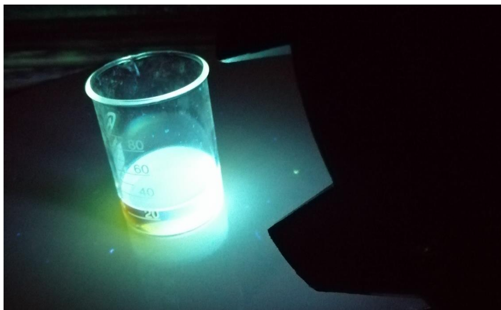
Figura 17. Emisión de solución de GQDs bajo una lámpara UV.
