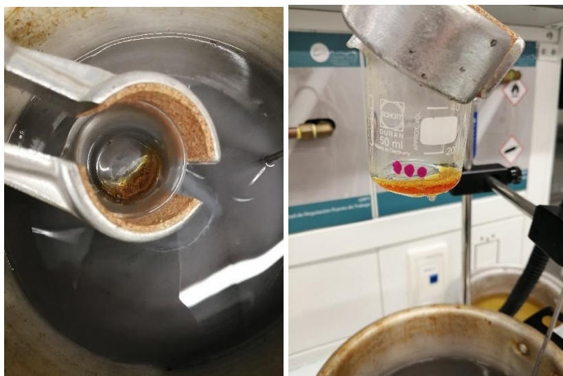
Figura 14. Calentamiento de ácido cítrico bajo baño maría para la obtención de GQDs
