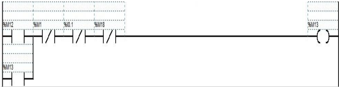
Figura 48. Programación LADDER línea 13 [45]
