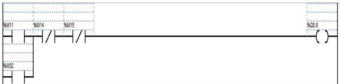
Figura 51. Configuraciones de salidas programación LADDER bobina 7M [45]
