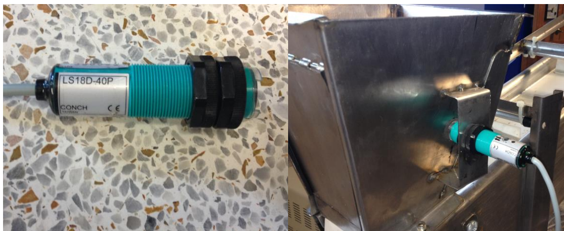
Figura 32. Sensor fotoeléctrico réflex LS18D-40P [35]
