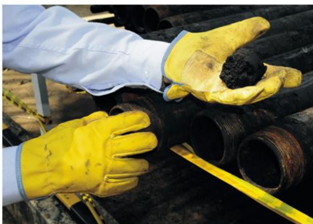
En la imagen se puede apreciar la parafina, uno de los principales inconvenientes de Campo Colorado y la industria en general. Uno de los proyectos busca darle solución a esta problemática.
