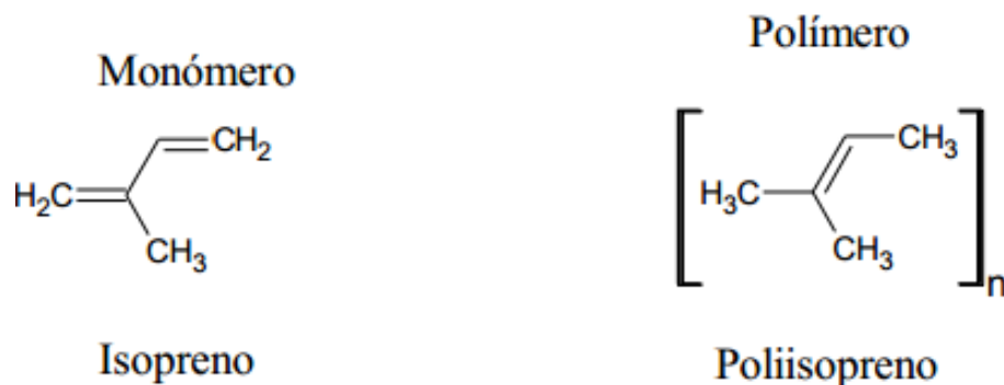
Figura 1: Estructura molecular del cacuho natural.
