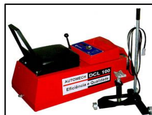
Figura 6. Balanceadora de carrito con luz estroboscópica
