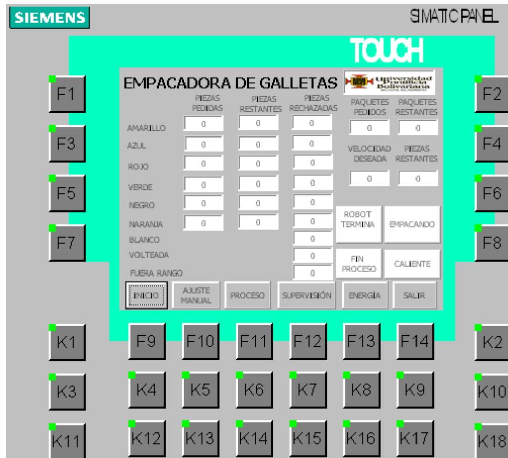
Figura 57: Ventana de supervisión de la HMI 65
