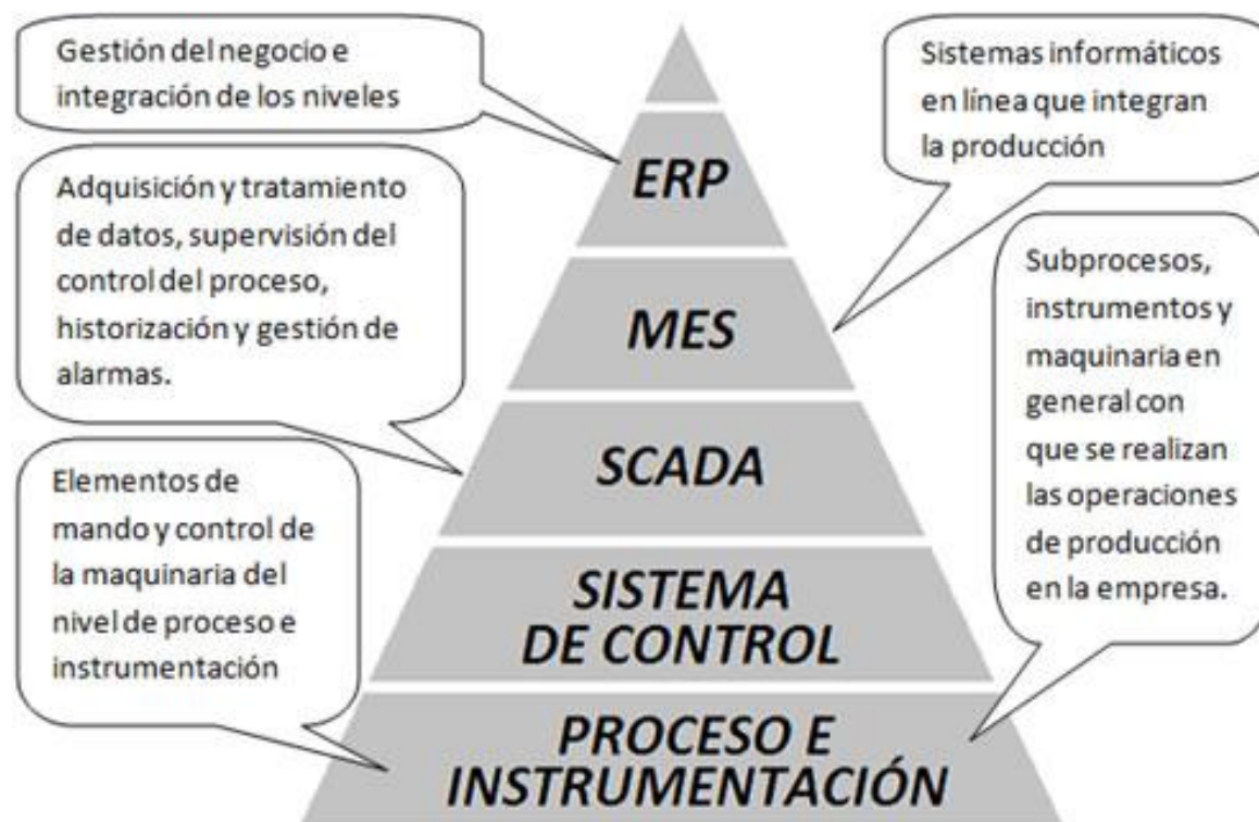
Figura 1: Pirámide de Automatización. 1
