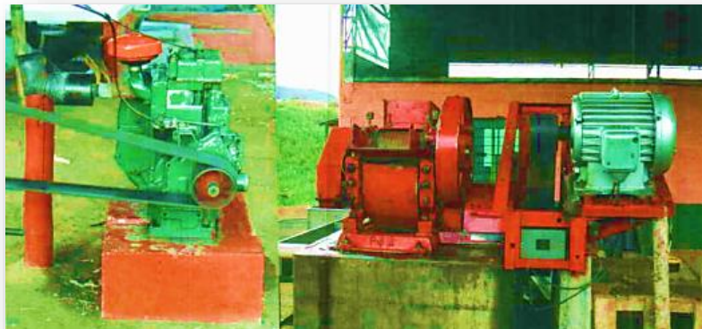
Figura. 3 Motor diésel y eléctrico para accionar molinos 8
