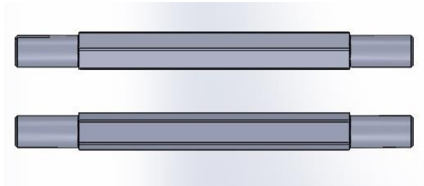
Figura. 11 Ejes de corte con sección pentagonal. 19
