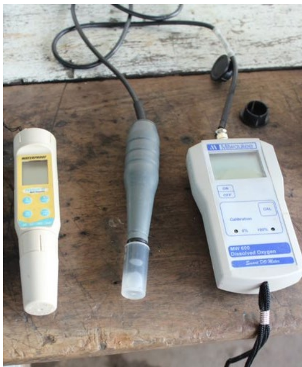
Foto 30. Equipos para el control de la calidad y oxigenación del agua.
