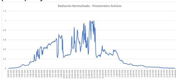
Figura 6. Curva de radiación del primer prototipo (tiempo de lectura cada 1 minuto).
