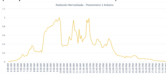
Figura 7. Curva de radiación del segundo prototipo (tiempo de lectura cada 5 minutos).
