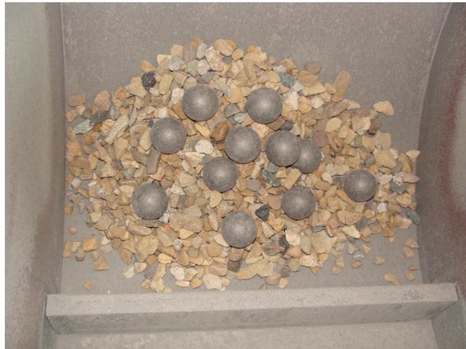
Figura 13 Muestra de agregado grueso y carga abrasiva en el ensayo de desgaste en la máquina de los ángeles
