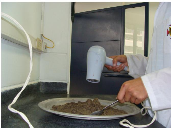
Figura 12 Secado de muestra de agregado fino en el ensayo de gravedad específica y absorción
