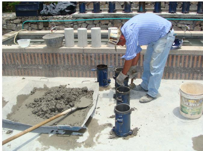
Figura 17 Elaboración de cilindros de concreto
