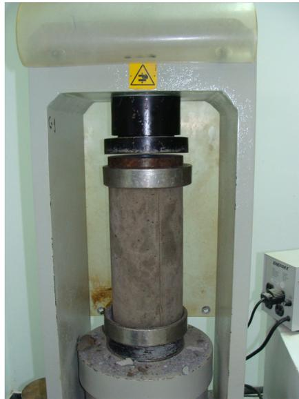
Figura 18 Elaboración de la prueba de resistencia a la compresión
