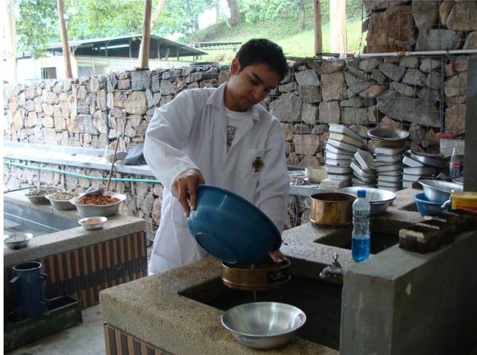
Figura 10 Proceso de lavado de las muestras
