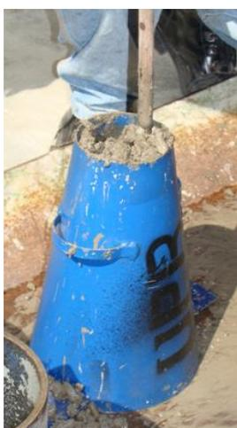
Figura 3 Ensayo de asentamiento
