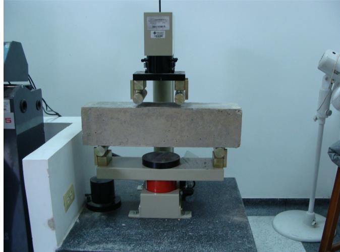
Figura 5 Ensayo de flexión con carga en dos puntos
