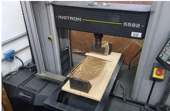
*Figura 8.* Montaje de la prueba de flexión con dos puntos de apoyo al ala con todas las venaciones.
