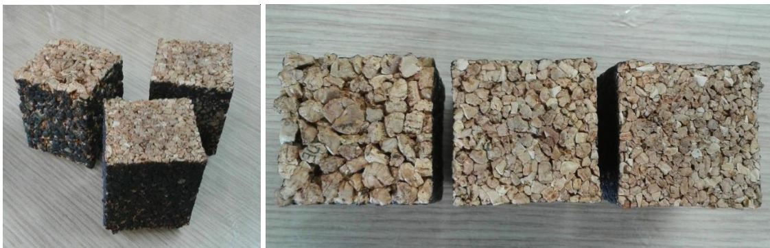
Figura 3. Probetas obtenidas de la aglomeración de corcho granulado con aglutinante de gelatina, con diferente tamaño de partícula.
