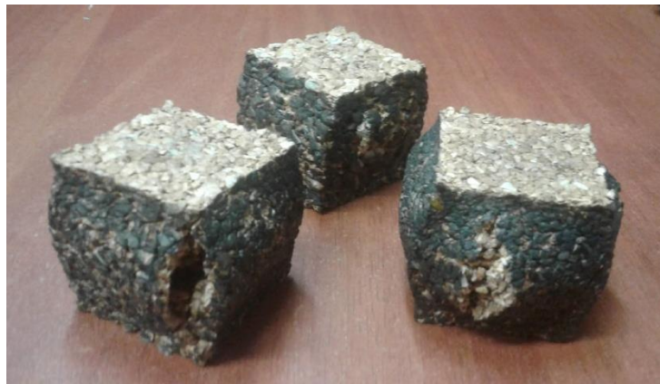
Figura 5. Probetas del aglomerado de corcho y gelatina después del ensayo de compresión.
