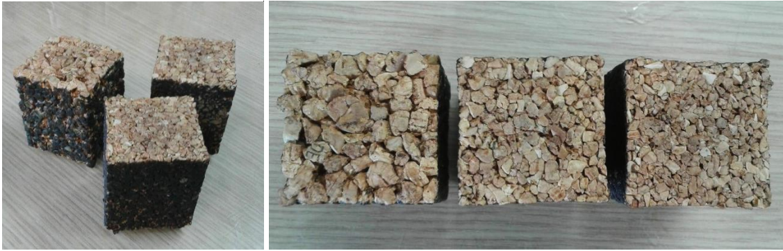
Figura 12. Probetas obtenidas de la aglomeración de corcho granulado con aglutinante de gelatina, con diferente tamaño de partícula.
