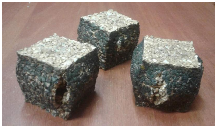
Figura 14. Probetas del aglomerado de corcho y gelatina después del ensayo de compresión.
