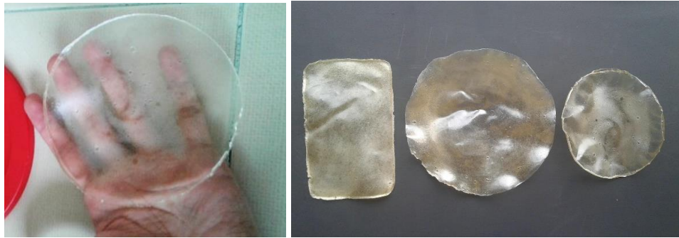
Figura 1. Primeras muestras del material natural de gelatina con diferentes concentraciones de Glicerina.
