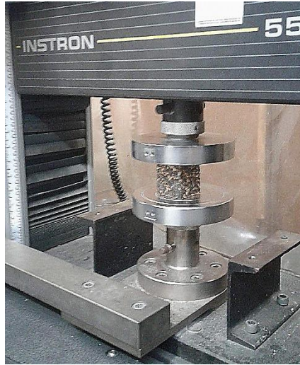
Figura 10. Disposición de las probetas en la maquina universal Instron para ensayo de compresión.
