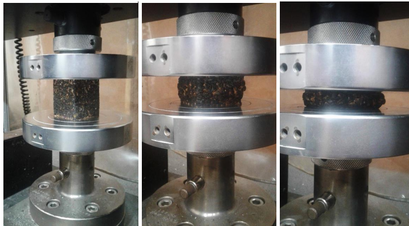
Figura 4. Comportamiento de la probeta ante esfuerzo de compresión.
