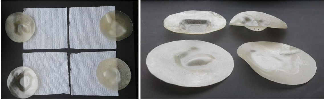
Figura 17. Muestras del aglutinante de gelatina después de la prueba de permeabilidad. (a) El papel absorbente no presenta señales de filtración de humedad. (b) Deformación sufrida por las muestras después de una hora.
