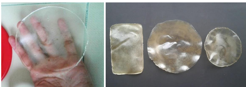
Figura 11. Primeras muestras del material natural de gelatina con diferentes concentraciones de Glicerina.
