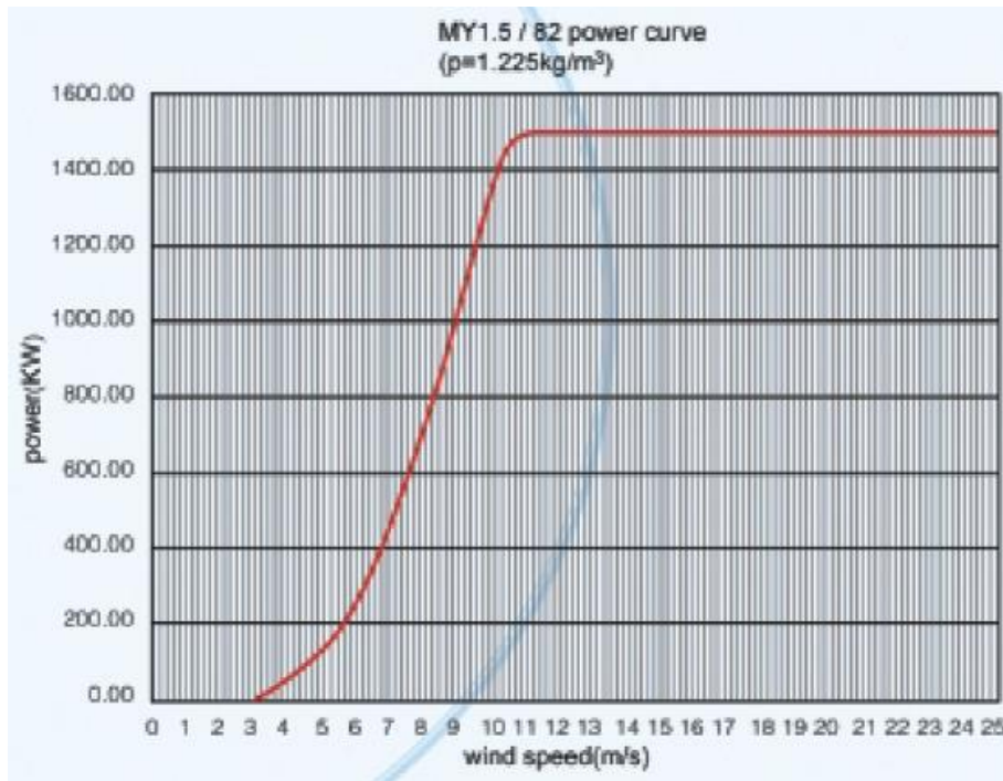
Figura 9-9 Curva de potencia Generador Ming Yang MY 1.5/82 MW
